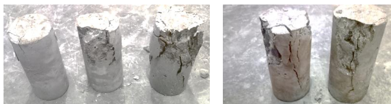
Gambar 4. Kegagalan Gabungan pada Benda Uji
