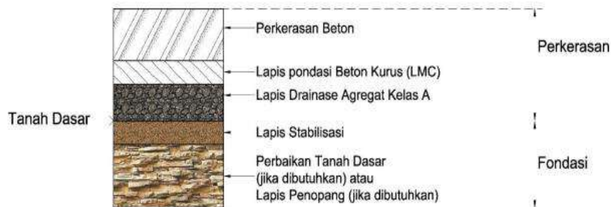
Gambar 2. Lapisan Stuktur Perkerasan Kaku
