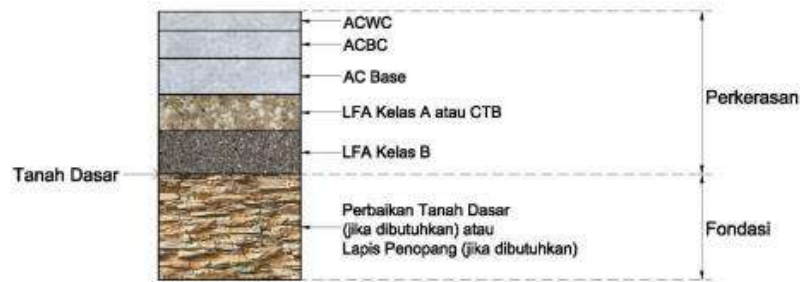
Gambar 1. Lapisan Stuktur Perkerasan lentur
